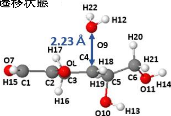
Fig.4-31 ①TS O9-H12-H22 の脱水の遷移状態
