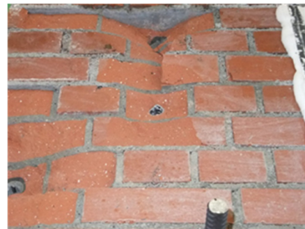
写真 7.2 破壊性状（樹脂注入タイプ：ra-Ta）
