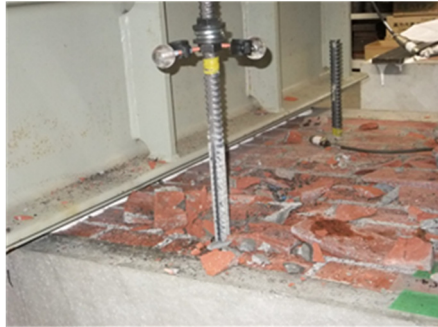
写真 7.1 破壊性状（グラウト充填タイプ：MR-Ta）
