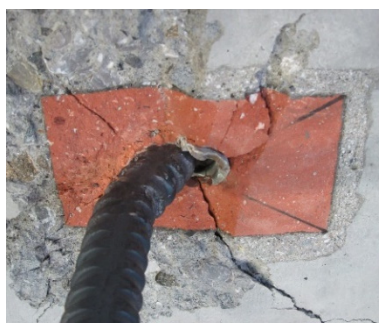
写真 7. 6 セン断実験破壊状況
