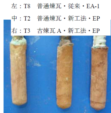
写真 7.9 アンカー筋破壊状況
