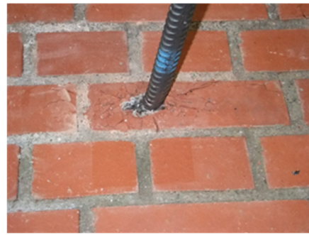
写真 7.4 破壊性状(樹脂充填タイプ : ra-Sc)
