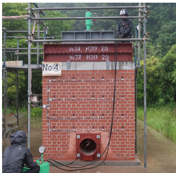
写真 5.3 実大長期載荷試験状況（試験体 4）
