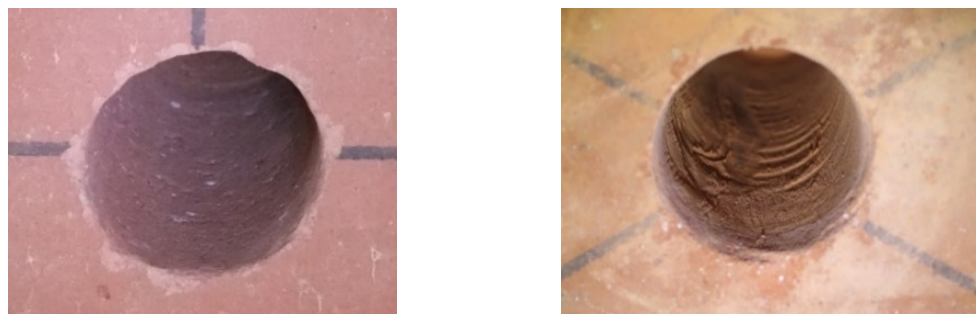
写真 7. 7 穿孔後孔壁状況 (a) 普通煉瓦湿潤状態 (b) 普通煉瓦乾燥状態 (7. 4 節の実験)
