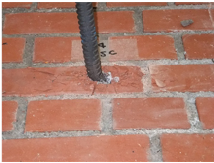
写真 7.4 破壊性状(樹脂充填タイプ : ra-Sc)
