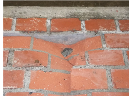
写真 7.1 破壊性状（グラウト充填タイプ：MR-Ta）
