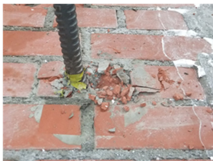
写真 7.3 破壊性状 (グラウト充填タイプ : MR-Sc)
