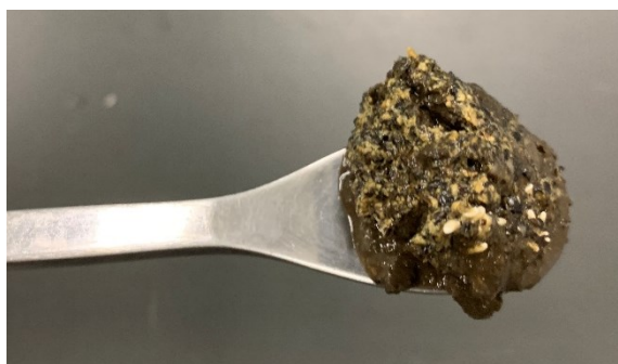
図 5.1.2 カラム解体時の油粕敷設層の様子
