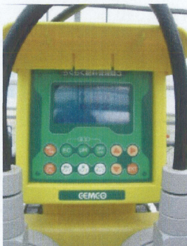
オートメーション化された機械（液化肥料を自動的に流す機械や自動で日を遮るカーテンを開け閉めする機械）
