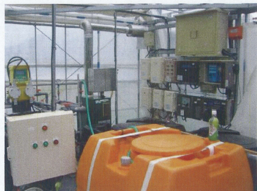
オートメーション化された機械（液化肥料を自動的に流す機械や自動で日を遮るカーテンを開け閉めする機械）
