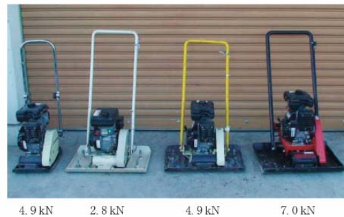
写真-1 ポーラスコンクリート用振動・仕上げ機（数値は起振力を示す）
