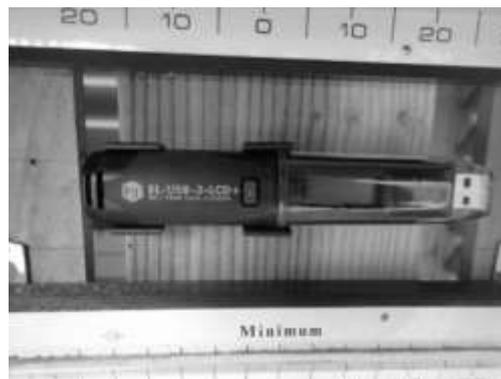
図2. 温湿度一体型センサ搭載データロガー (EL-USB-2-LCD+).
