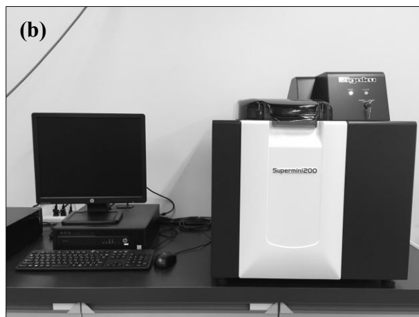
図 2 (a) 熱分析システム、(b) 波長分散小型蛍光 X 線分析装置
