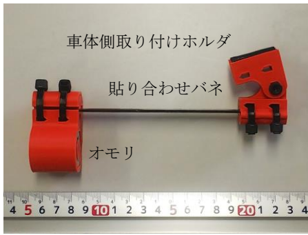
図1 製作したダンパー
