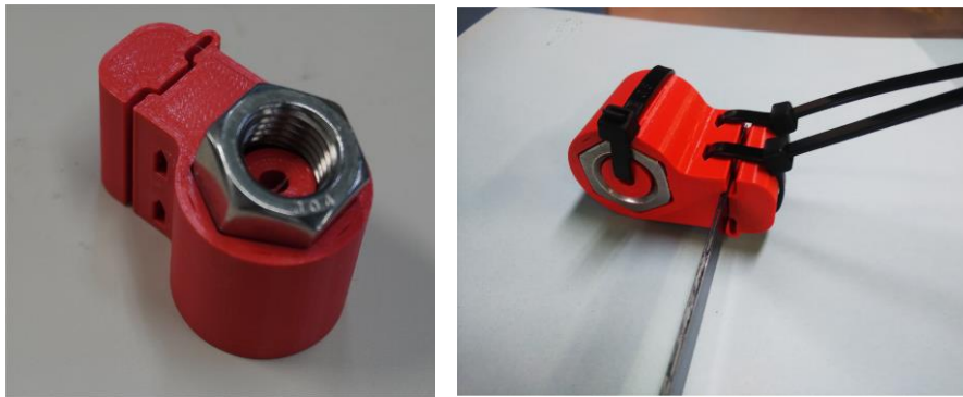
図5 設計上の工夫（スリットと結束バンドによる締結）
