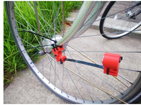
図2 ダンパーの使用例
