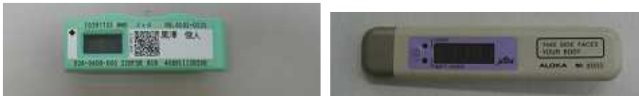
図 1 . ガラスバッジ (左) とポケット線量計 (右)
