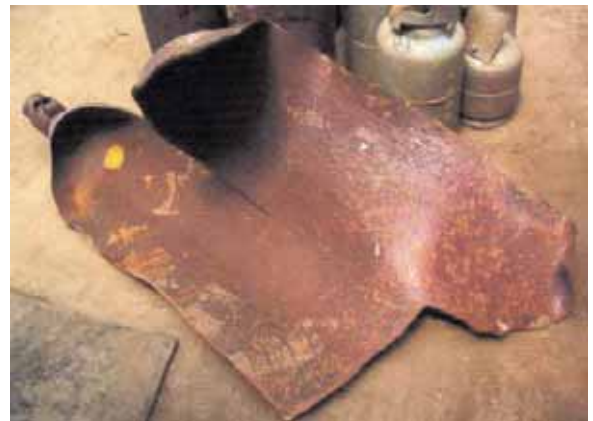
写真4 (事故例) 破裂したガスボンベ
