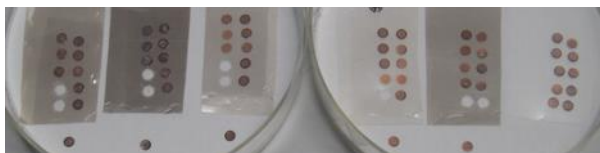
図3. 各条件でのコーティングの状態（左から条件①、②、③、④、⑤、右端は無蒸着）
