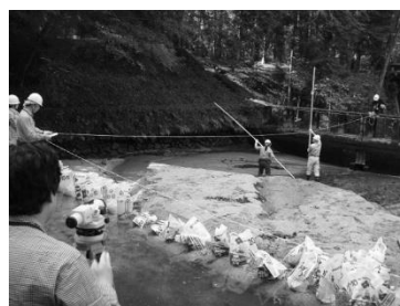
図 2. 堆積土砂量の計測
