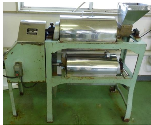
第1図. 2段式パルプフィニッシャー (左図：メッシュを取り付けた状態，右図：使用時の状態)
