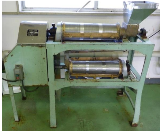
第1図. 2段式パルプフィニッシャー (左図：メッシュを取り付けた状態，右図：使用時の状態)
