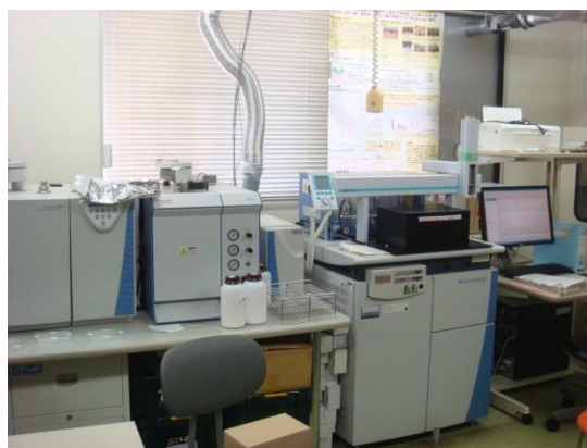
写真1 安定同位体比質量分析システム
