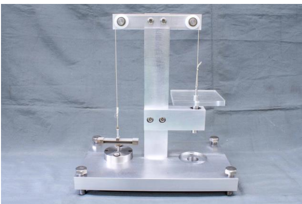
図4 引張・圧縮試験機(左が引張時、右が圧縮時)
