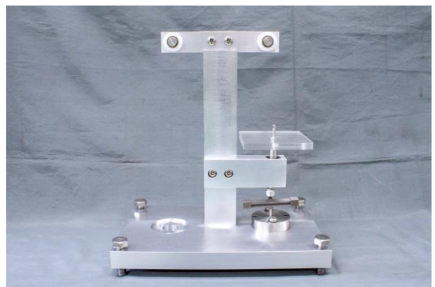
図4 引張・圧縮試験機(左が引張時、右が圧縮時)
