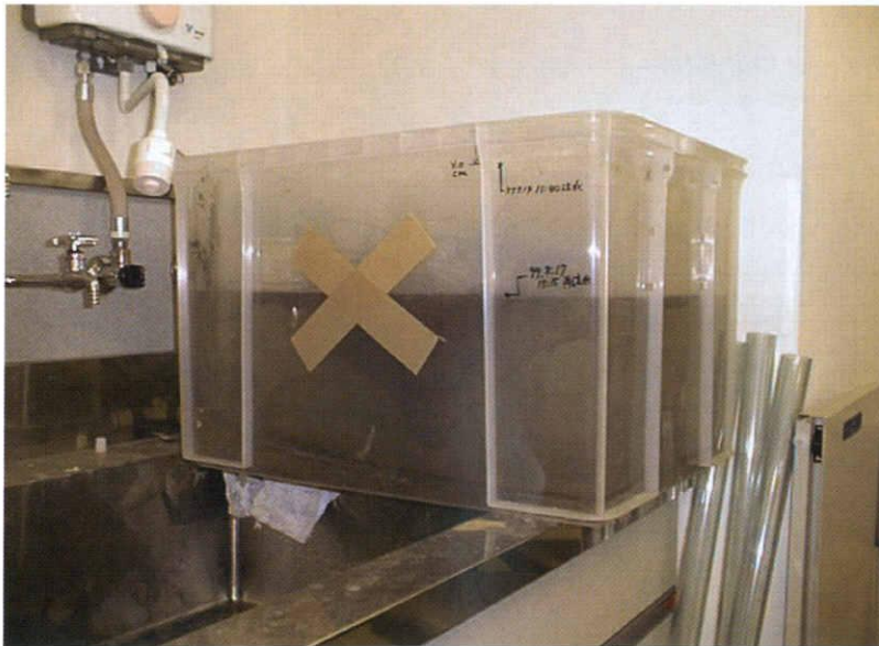
写真2 底をVの字にして容器内で泥炭塊が浮いている様子 (1999年8月17日)
