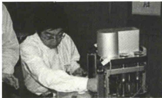
図 2-9-9 町家プレスで薄板を型抜き
