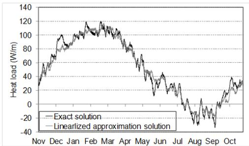
図6 地下室の貫流負荷比較 (GL-3.0m)
