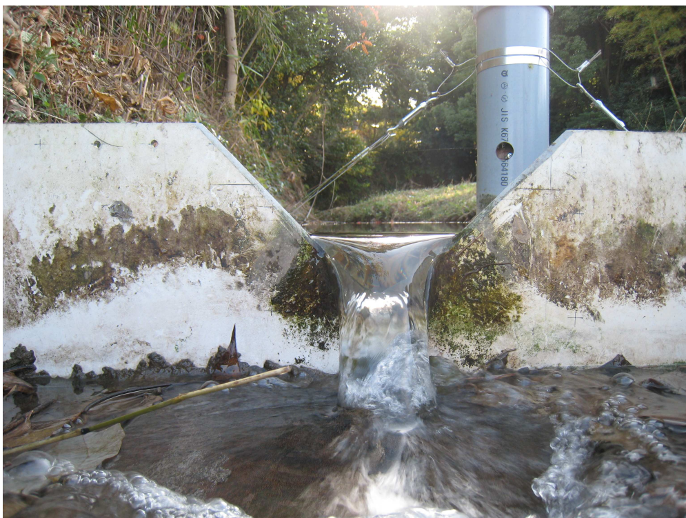
図 3-3-3 沼沢内南西部、三角堰付近測定箇所（水位計データロガー） （2010年12月7日 筆者撮影）
