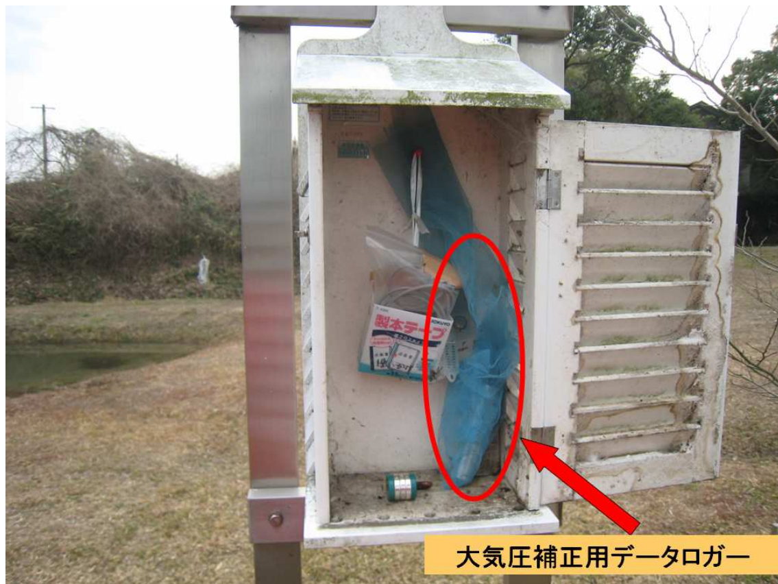
図 3-3-9 百葉箱内部 (大気圧補正用データロガー) (2011年1月6日 筆者撮影)
