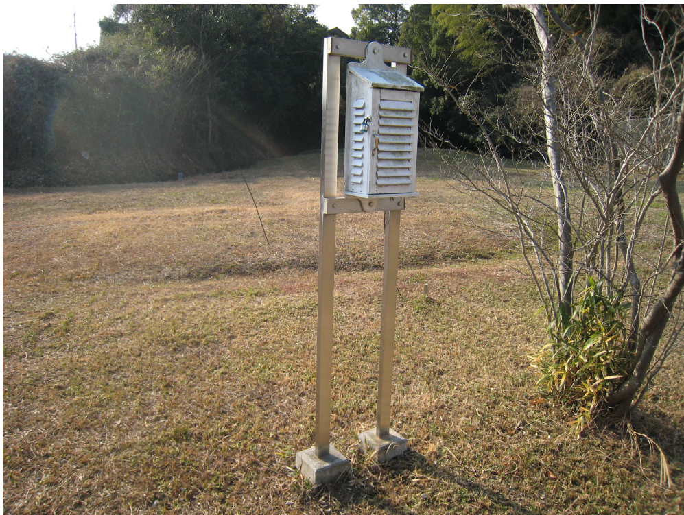
図 3-3-8 沼沢内中央部、百葉箱内部測定箇所（大気圧補正用データロガー） (2011年1月6日 筆者撮影)
