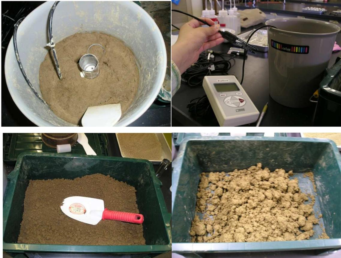
Fig. 3-7 加水実験の様子（上段：実験手法，下段左：乾燥状態の土壌，
