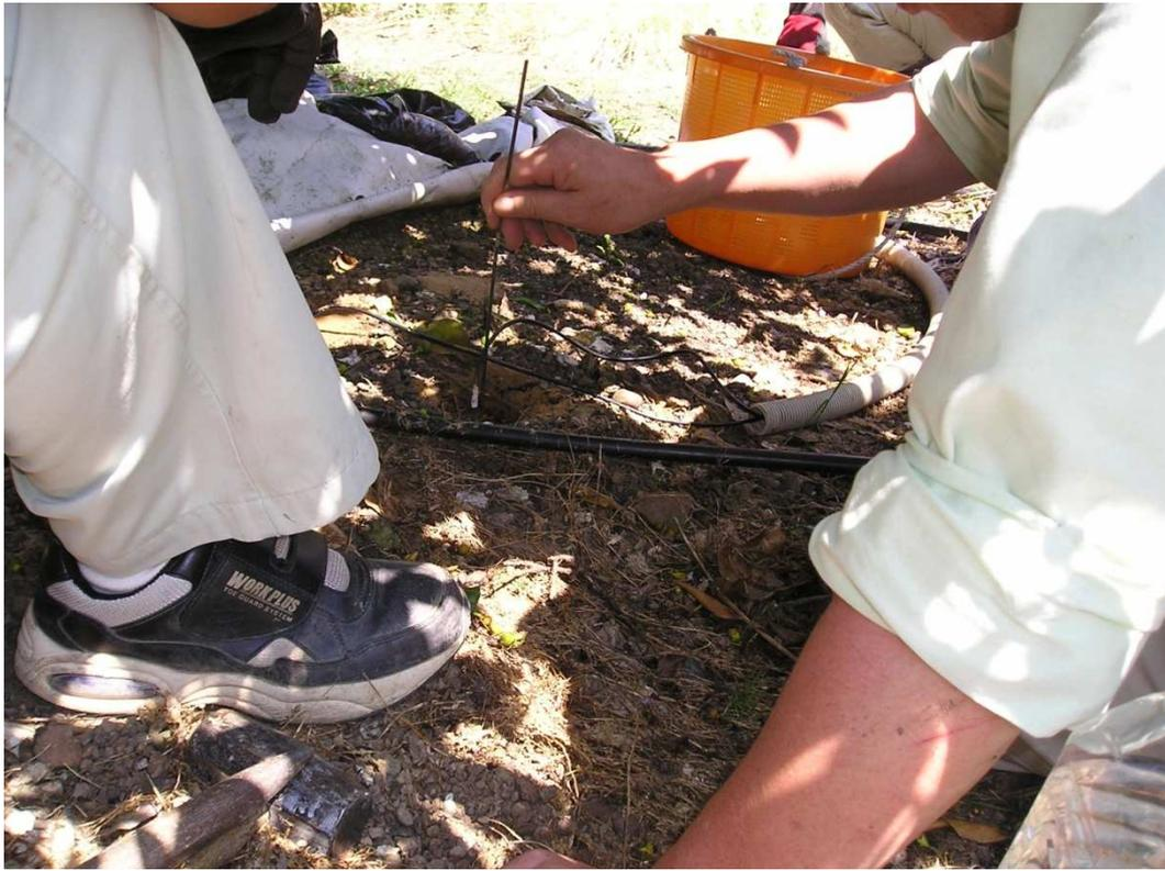
Fig. 3-5 土壤水分センサ設置風景
