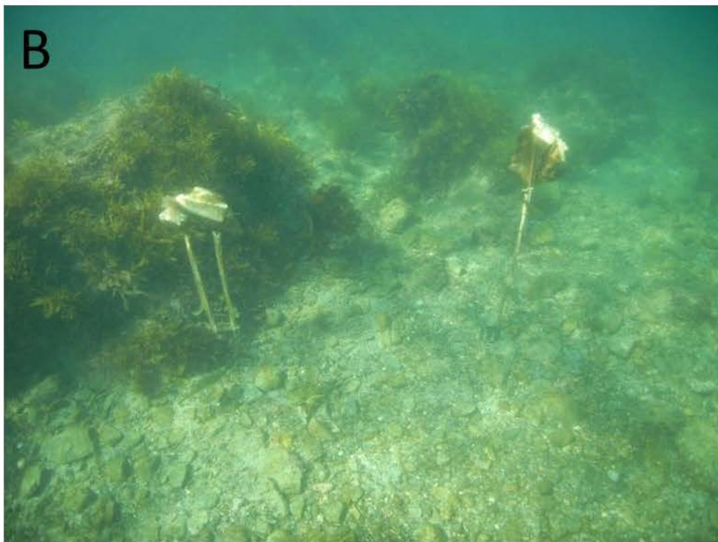
Fig. 23. 英虞湾浜島において行った布を人工海藻にみたてた実験. 布素材: テトロン 60%、綿 40%.
