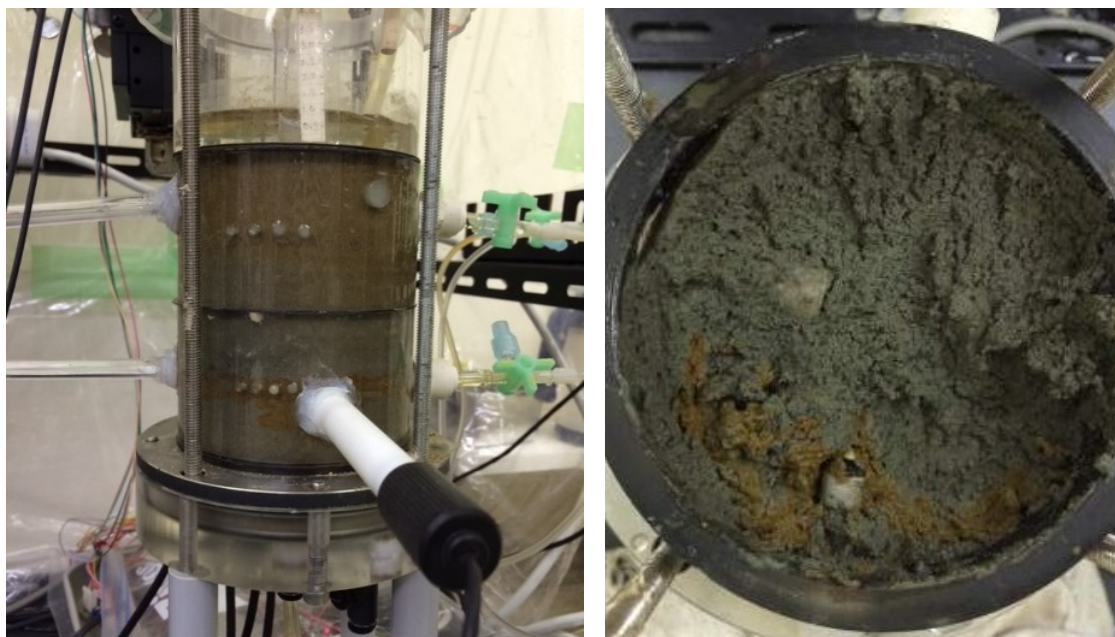
図 7.2 酸化した様子 左は実験中、右は実験終了後カラム解体時に撮影した(9/29 実験)。
