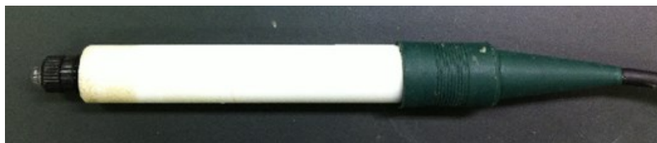
図 3.3.4 藤原の pH センサ
