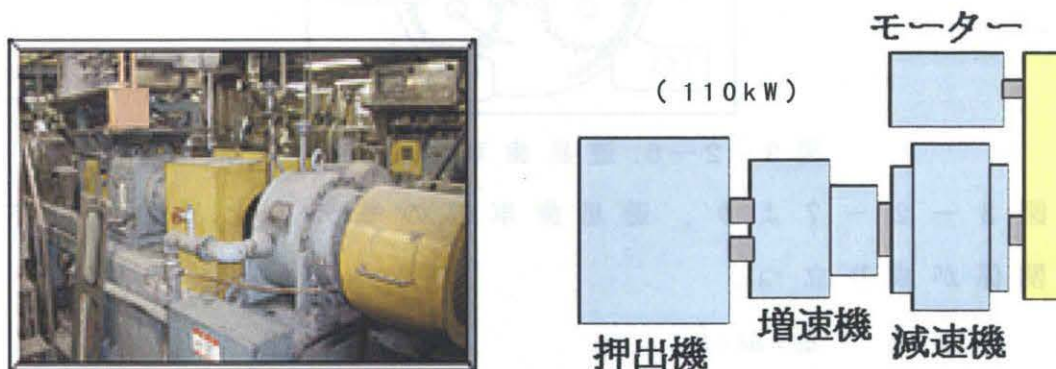
図3-2-5 減速機装置概略図
