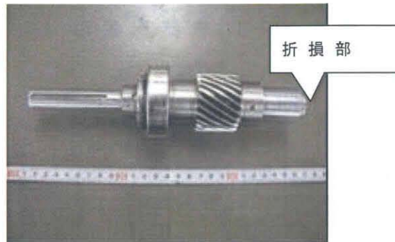
図3-3-3 折損した変速機側軸
