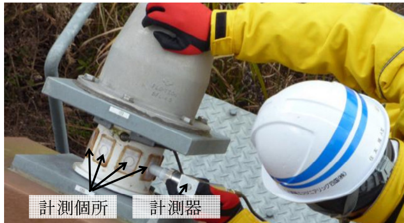
図-4.2 磁歪式の荷重計（Mリング）
