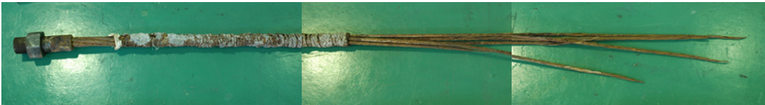
図-3.28 鋼材検査の対象としたアンカー材 (No.3)
