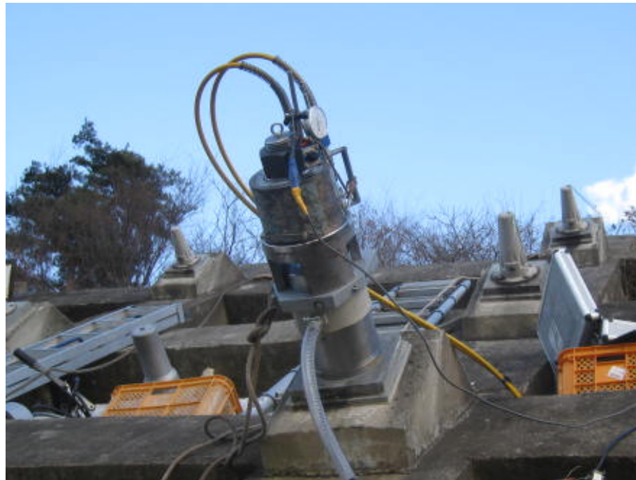
(b) リフトオフ試験の状況
