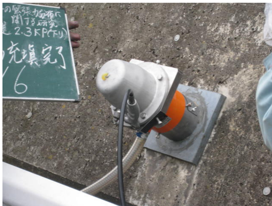
図-4.24 荷重計の計測値のモニタリング (SEEE工法)
