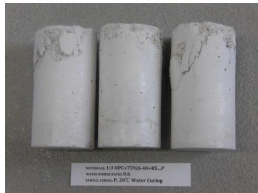
Materials: 1:3 OPC+75%S-40+RS...P Curing: 20°C Water Curing
