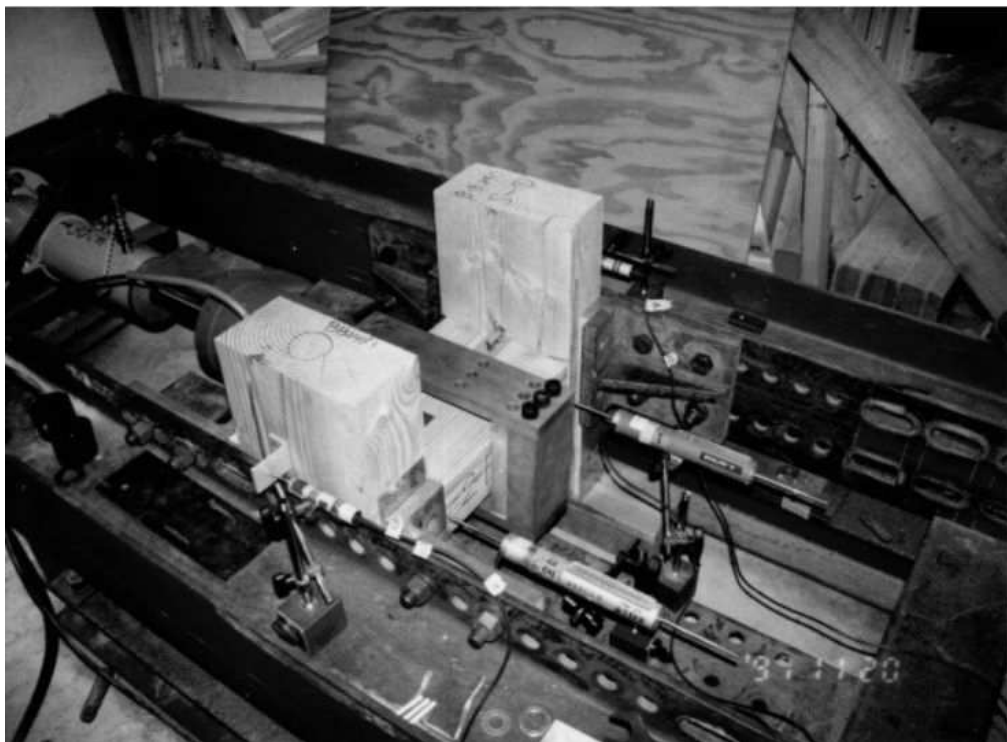
Fig.3.5. 梁-梁仕口の加力および変位測定方法 (BB タイプ)
