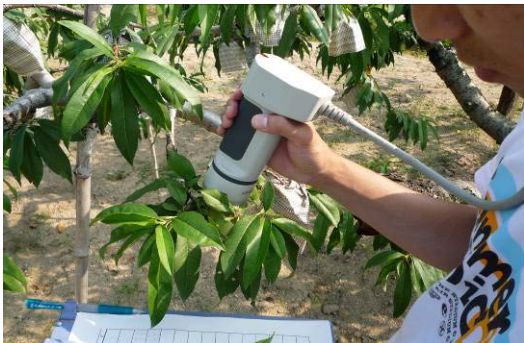
図1 色彩計による表面色測定
