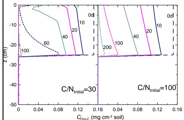
Fig. 1 土中の有機物分解に伴う有機炭素分布の変化
