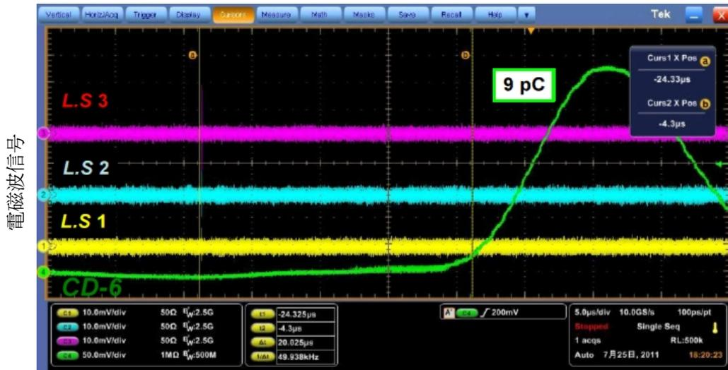
図 6-10 CD-6 及び L.S. で取得した放射電磁波波形 ( $V_a = 12.4 \text{ kV}_{\text{rms}}$ ,  $2a = 0.21 \text{ mm}$ )
