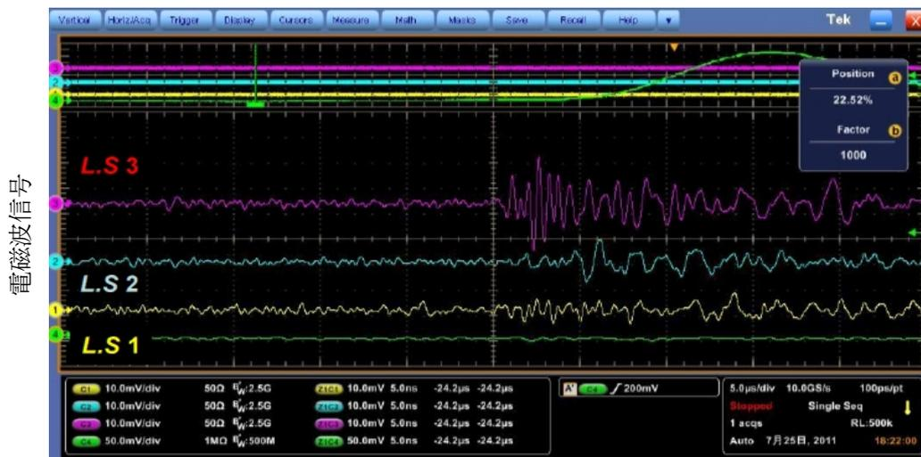
図 6-11 L.S. で取得した放射電磁波波形 ( $V_a = 12.4 \text{ kV}_{\text{rms}}$ ,  $2a = 0.21 \text{ mm}$ )
