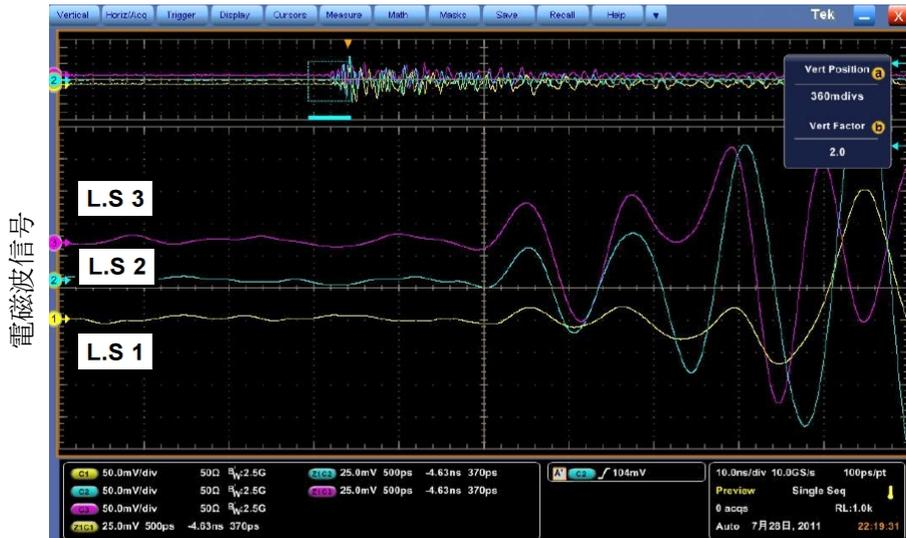
図 6-31 L.S によって検出された電磁波波形（ケース 1，健全 VT，phase to phase）
