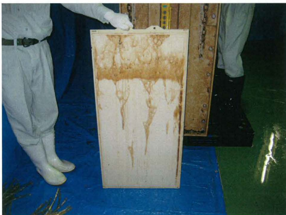
図 2-4. 本研究で用いた実験中の PTFE 平膜（凝集膜）
