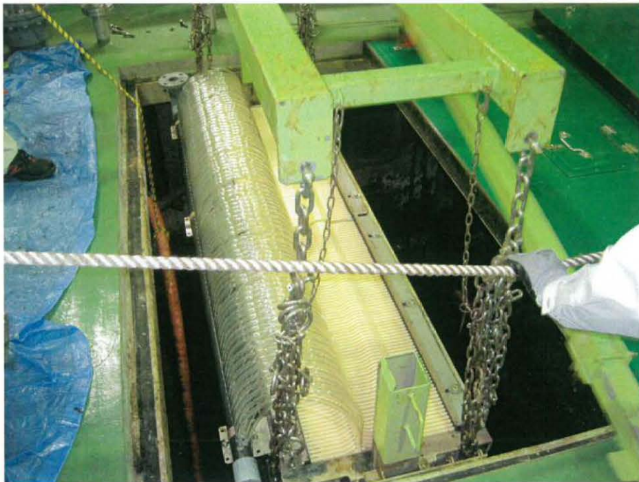
図 2-1. 本研究で用いた生物膜分離装置（生物膜原水槽）
