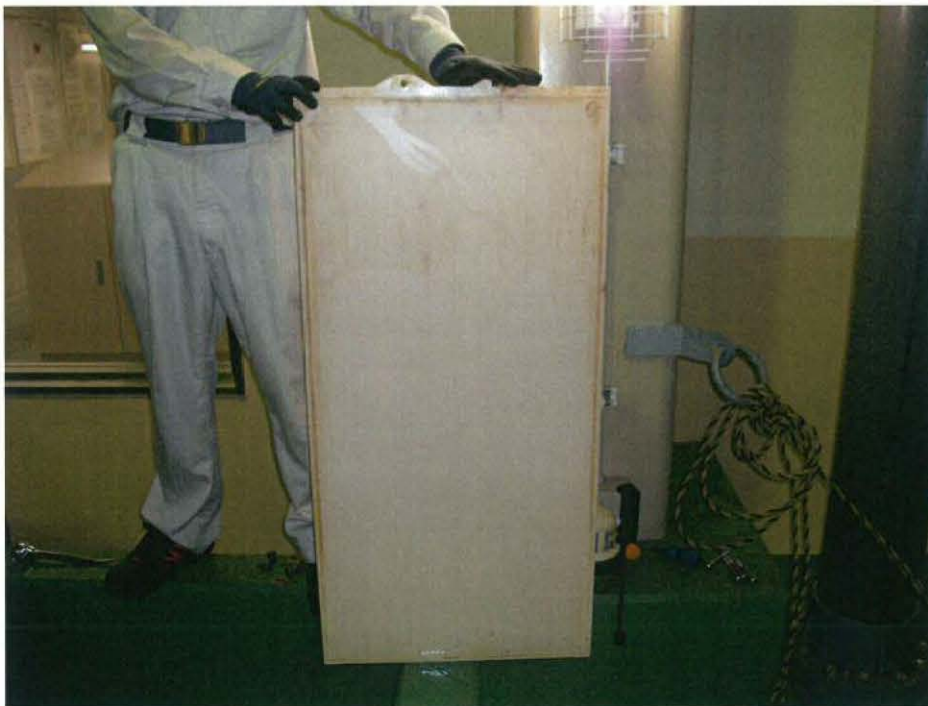
図 2-2. 本研究で用いた実験中の PTFE 平膜（生物膜）
