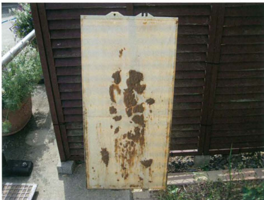
図 4-5. 回収した PTFE 平膜
