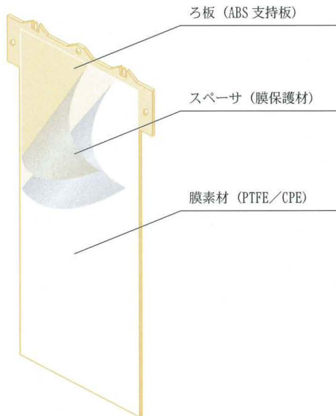
図 2-6. 平膜の構造図
