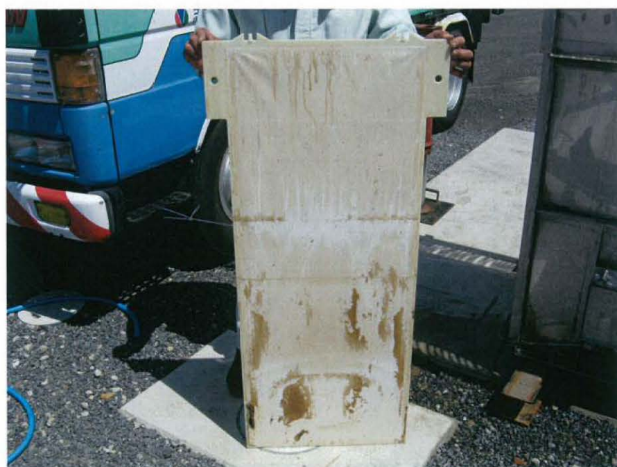
図 5-32. PTFE 平膜の外観状況
