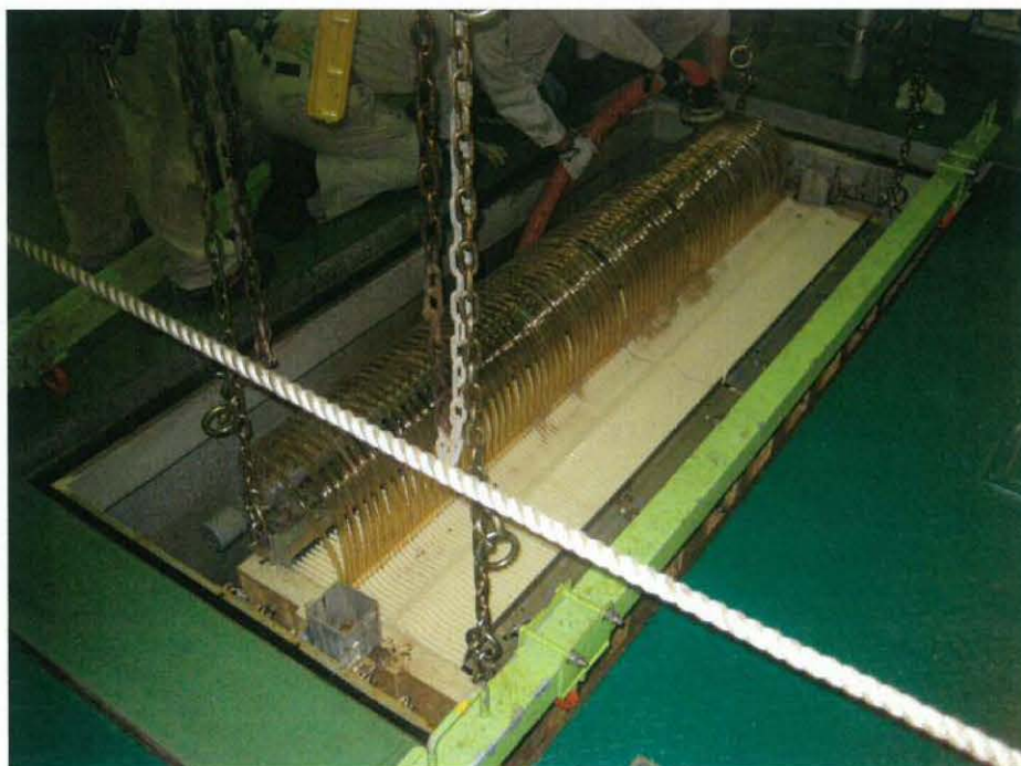
図 2-3. 本研究で用いた凝集膜分離装置（凝集膜原水槽）
