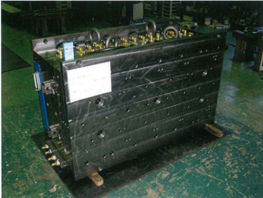
図 7-4. 平膜ろ板の金型（志摩市）
