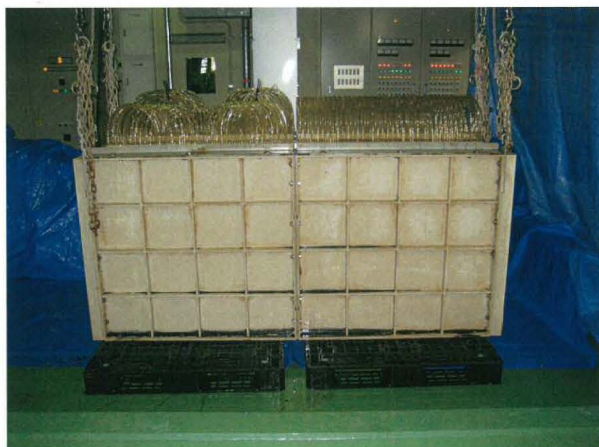
図2-17. 平膜枚数を半分にした凝集膜分離装置 (Flux 0.7 \text{ m}^3/\text{m}^2 \cdot \text{day} )
