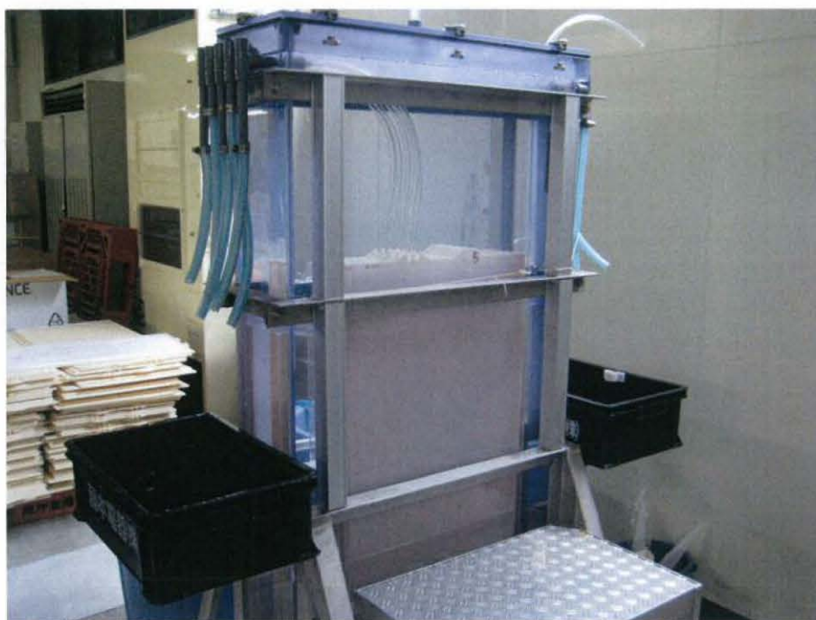
図 4-6. 清水透過水量試験器
