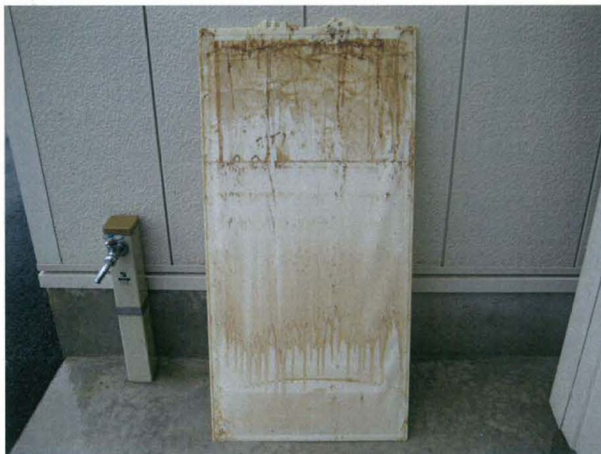
図 3-14. 実験で使した PTFE 平膜
