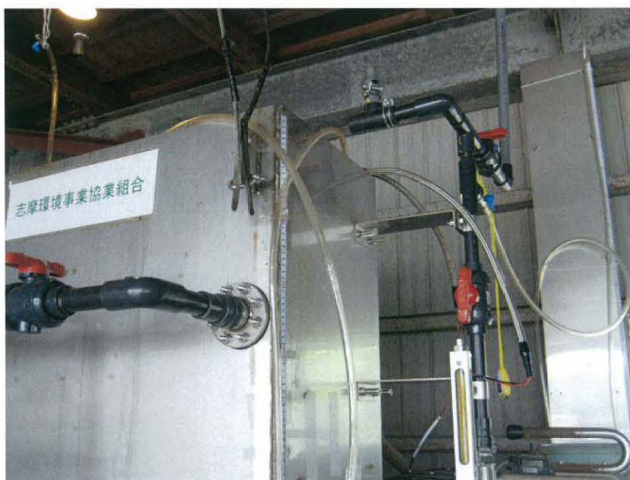
図 3-10. マノメーター（透明チューブと巻尺で作製）
