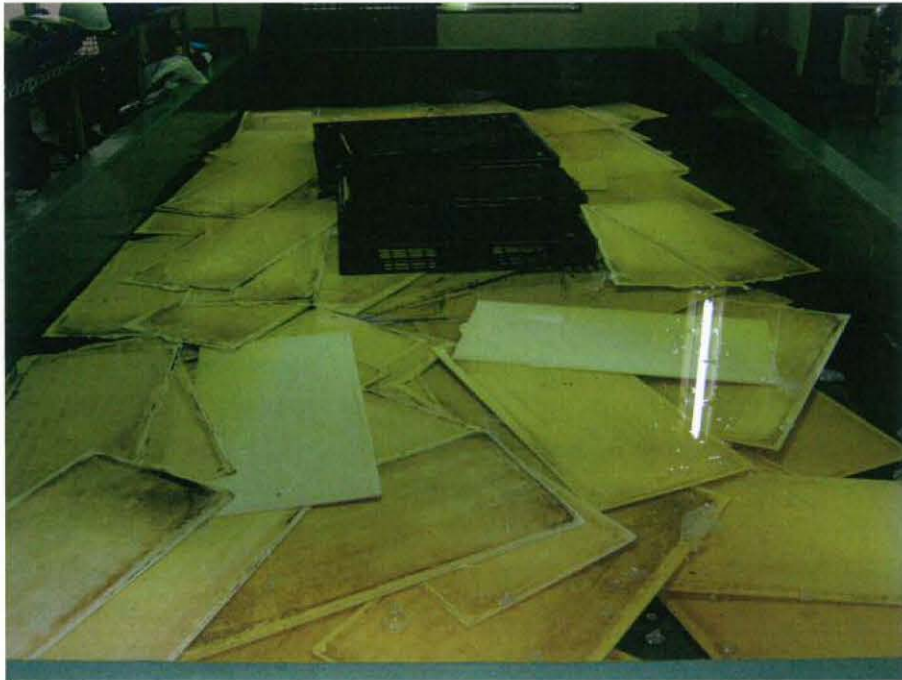
図 2-23. 槽外浸漬洗浄（クエン酸洗浄）
