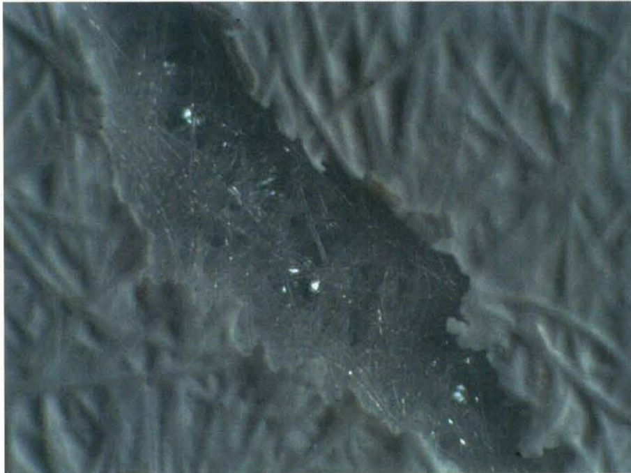
図 1-23. 超音波照射による CPE 平膜の破損事例（光学顕微鏡 40 倍）
