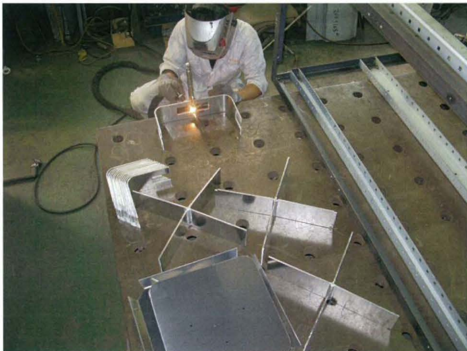
図 7-5. SUS ケーシング製造（鳥羽市）
