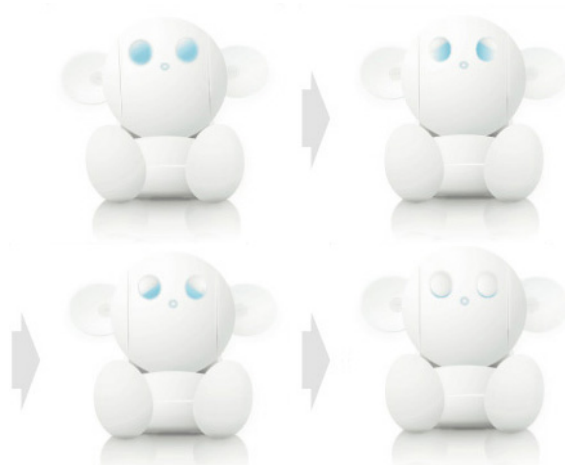
図 1-10 卓上会話ロボットの動作説明図（LED 表示による瞬き）
