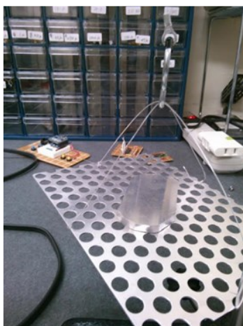
Fig. 39 BMF の荷重実験
