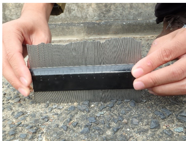
図 34 型取りゲージ測定手順－1
