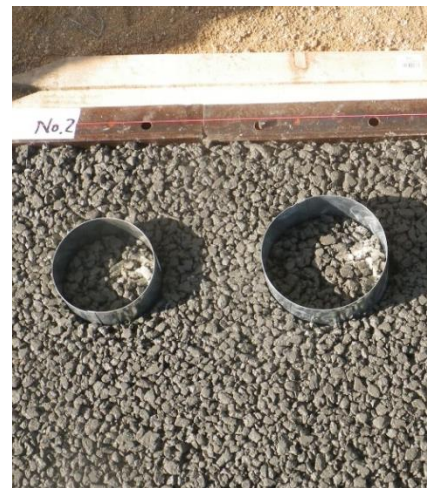
(b) フレッシュポーラスコンクリートに打ち込まれた鋼管
