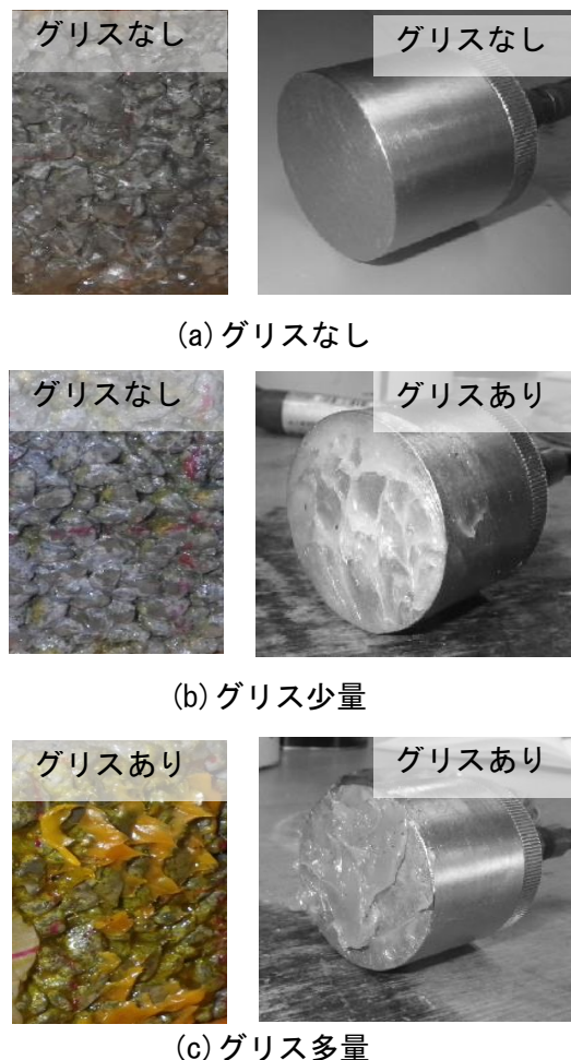
写真 5.2 測定前の接触面のグリスの使用量 (左:試験体側, 右:発振子)
