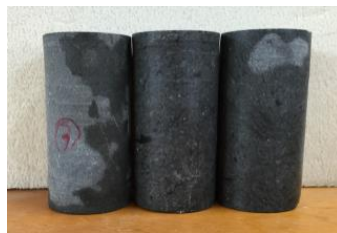
対面法用 (φ50×100mm) 表面法用 (測定距離: 100mm)
