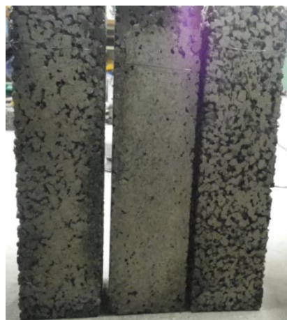
写真 3.2 試験体の底部の垂れの状況の例
