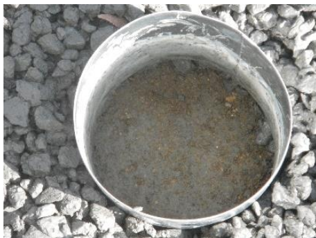
(c) 鋼管内部の試料の採取後
