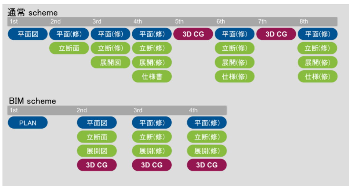
図 1.1 BIM 利用によるワークフロー
