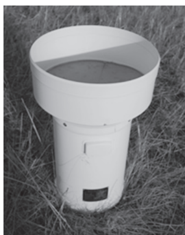
図2 0.2mm まで分解能を上げる円筒外径を増設した転倒ます式雨量計
