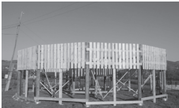
図4 モンゴル・ウランバートル Selbe 川流域に新設された基準降水測定サイトの降水測定用二重柵（2016年11月）
