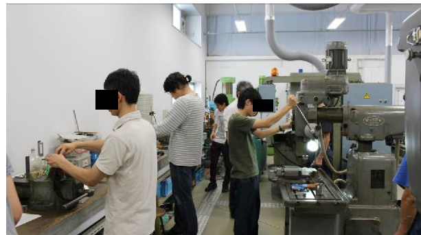
ボール盤作業、ネジ切り作業
