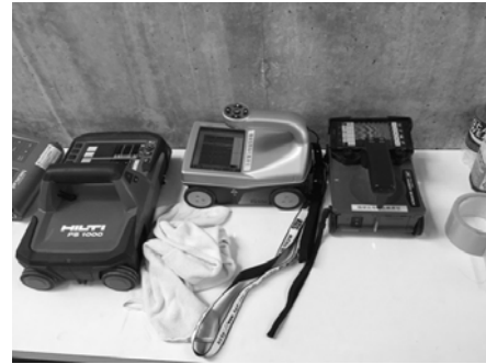
写真-4 電磁波レーダー法の機器の一例
