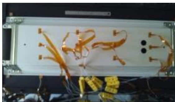
図6.21 室内放熱測定風景 (左：照明器具を置く前の冷却面, 右：照明器具を置いた状態)
