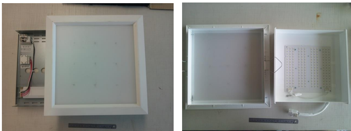
図6.10 試験に使用したLED照明器具. 左：室内側，右：照明器具の内部
