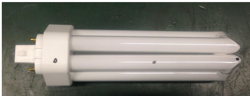
図6.9 試験に使用したスクエア型照明器具用の蛍光灯（昼白色）
