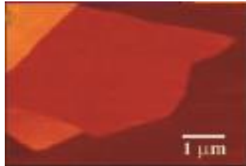
図 1.1 SiO 2 に転写したグラフェンの AFM 像([13]より引用)
