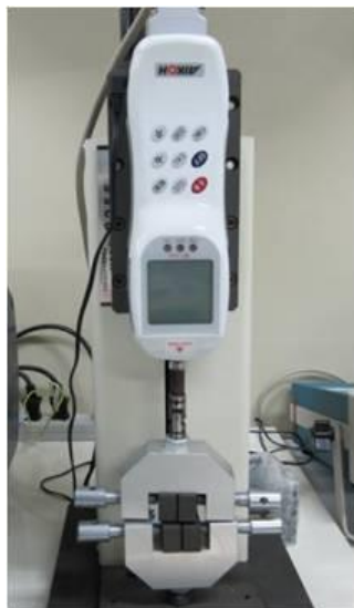
図 3.2 引っ張り試験装置の写真
