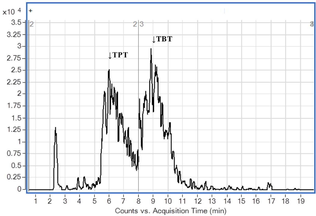
図2-11 ODS系カラム使用した場合のTBT及びTPT標準液のLC/MS/MS測定によるSIMクロマトグラム (1 mg/L)
