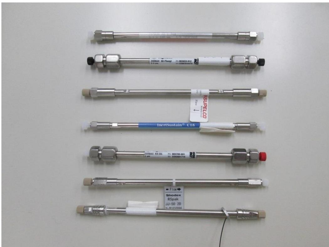
図 1-11 HPLC 法及び LC/MS/MS 法に使用される分離カラム
