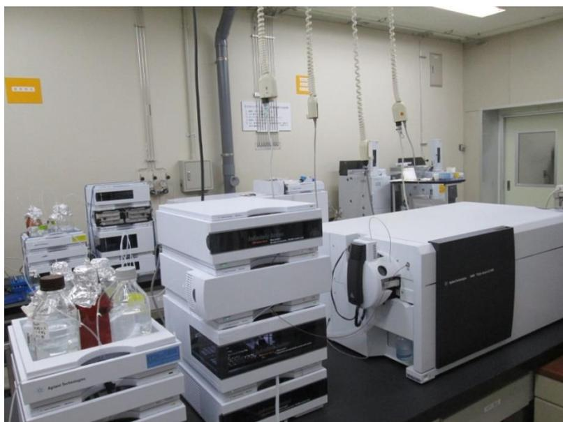
図 1-7 LC/MS/MS 装置の外観 (Agilent 製)
