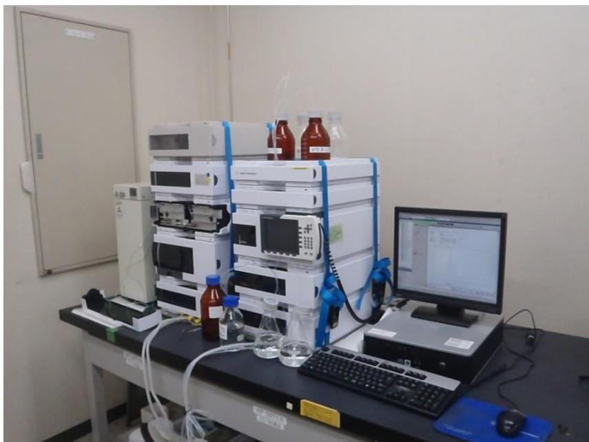
図 1-10 HPLC 装置の外観（Agilent 製）
