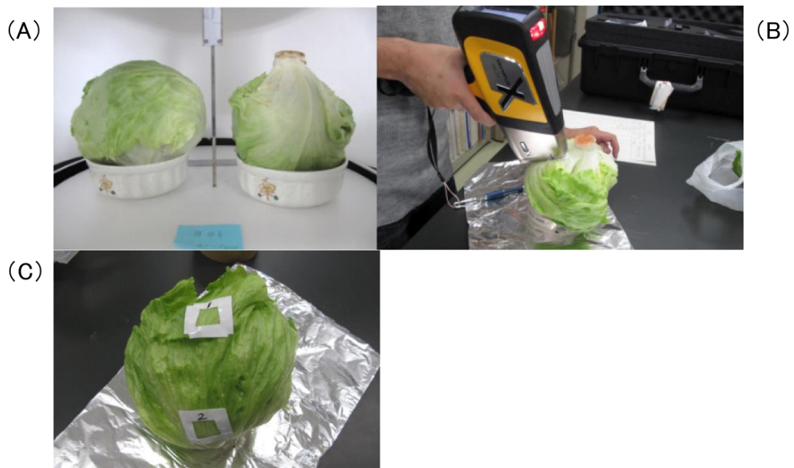
図 4.5 実験風景 (A) 撮像システムへのレタス設置風景。(B) 蛍光 X 線分析装置による結球レタスの計測風景。(C) 計測箇所の様子。
