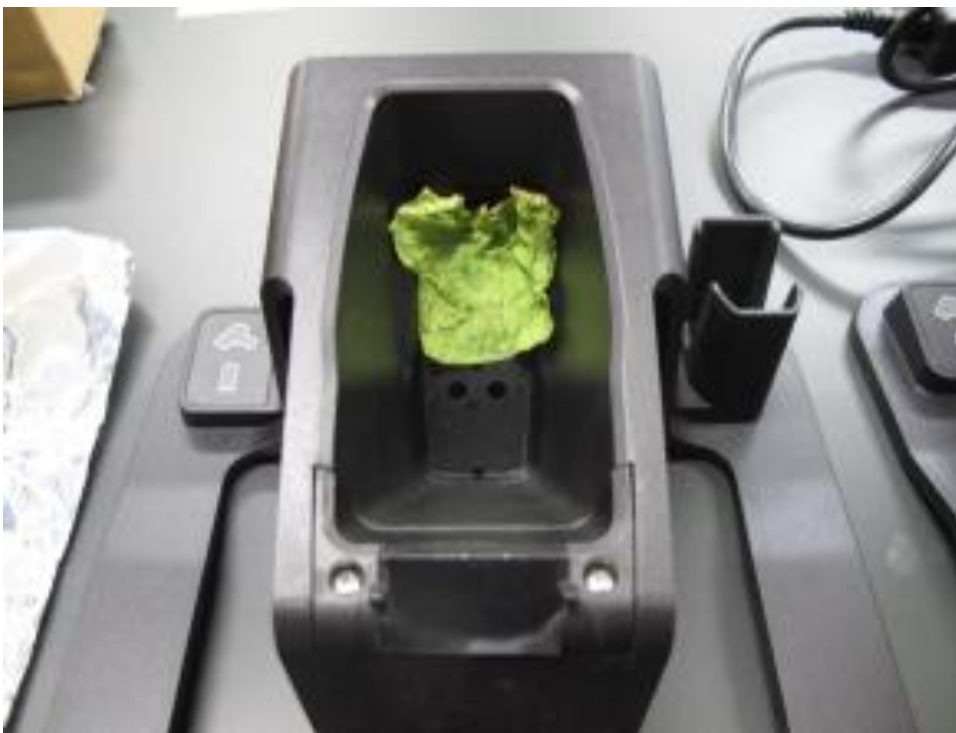
図 4.7 蛍光 X 線計測スタンドに葉サンプルを設置した様子
