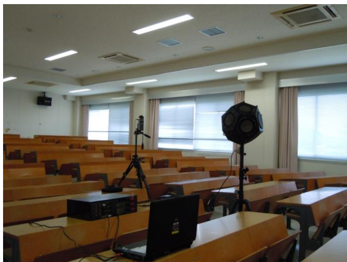
写真 1 インパルス応答の測定模様
