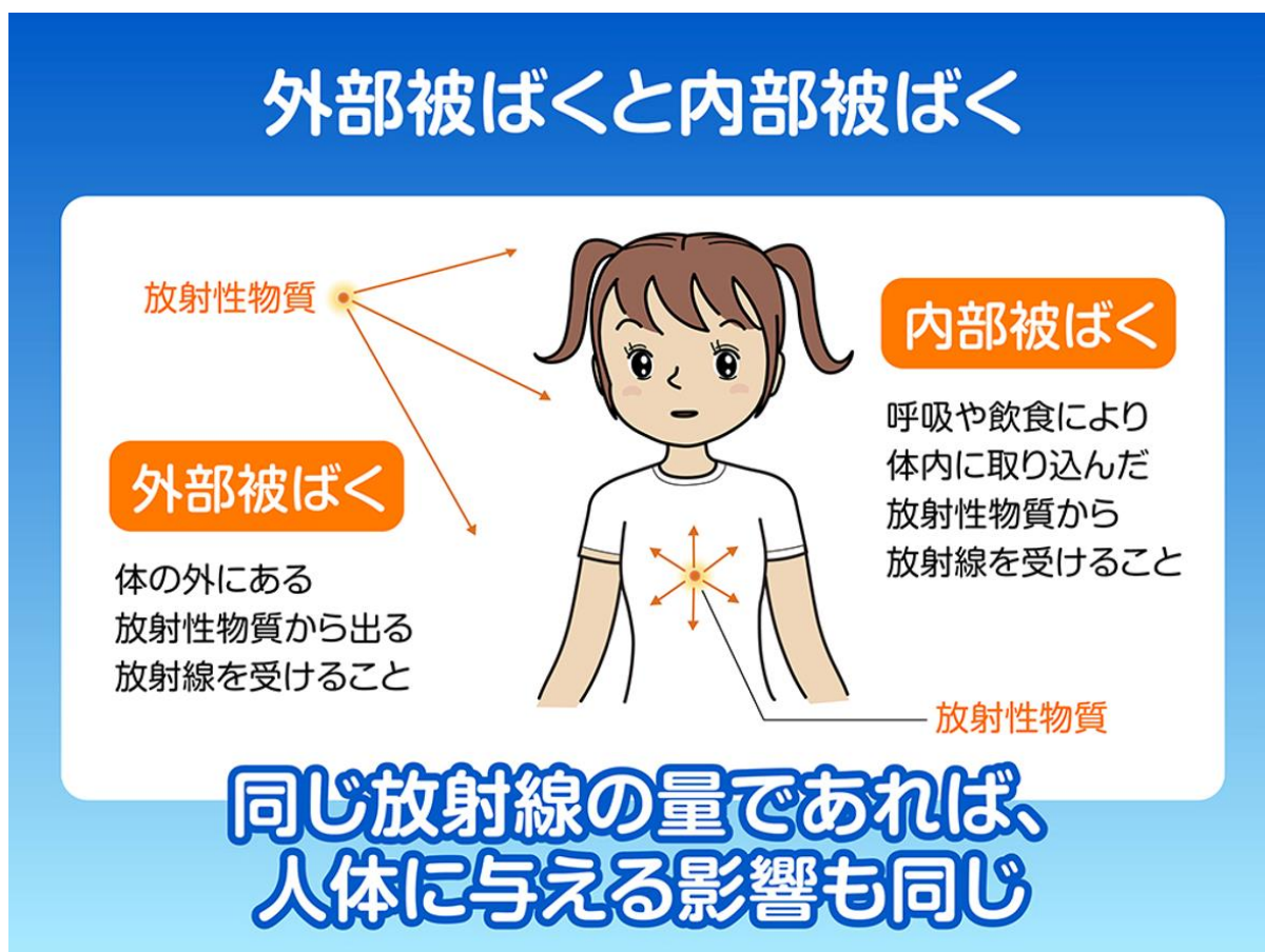
図 23：内部被ばくと外部被ばく (中部電力株式会社 (2015)「出前授業資料」より)
