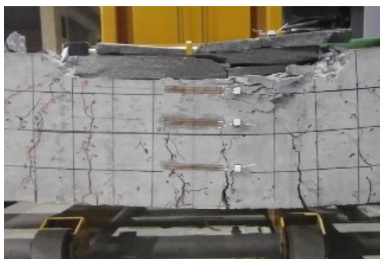
d. RB 補修 (付着不良)
