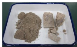
図2-33 加熱前後の供試体の状況 (左：OPC，右：GP (BS10%))
