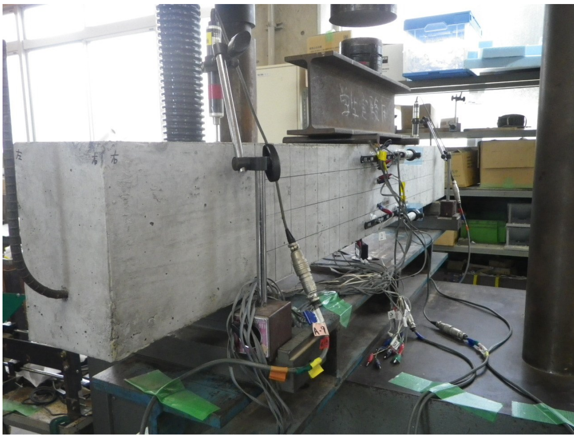
写真 3-6 曲げ試験の様子
