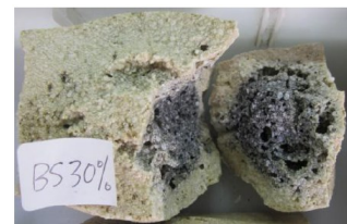
図2-34 加熱に伴う供試体の膨張 (GP (BS30%)，材齢7日)
