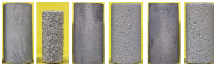
図2-27 硫酸浸漬前後の外観の比較 (浸漬材齢8日)
