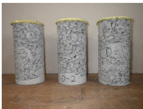
写真 3-3 ジャンカ円柱供試体
