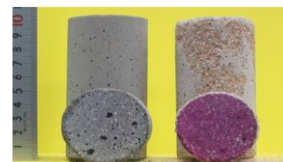
(a) 浸漬材齢20週の外観と切断面 (左：GP(BS10%)，右：OPC)
