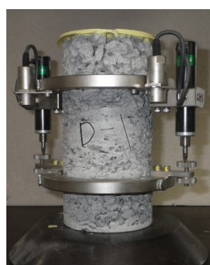
写真 3-4 ジャンカ円柱供試体に コンプレッソメーターを設置した状態
