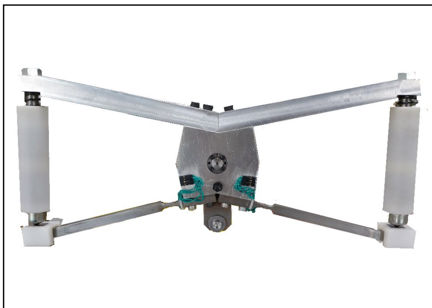
Figure 2.9 ステアリング詳細図
