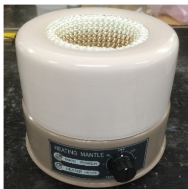
図 2.24 マントルヒーター（製造：AS ONE、型番：HB-300T）
