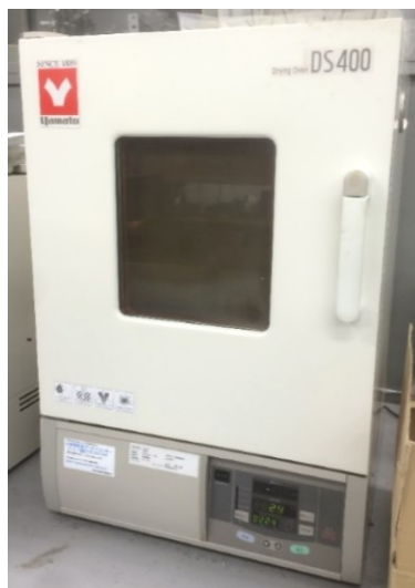
図 2.26 乾燥機（製造：YAMATO、型番：DS400）
