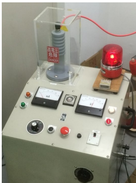
図 2.27 交流電圧源（製造：京南電機、型番：YPA-00520）
