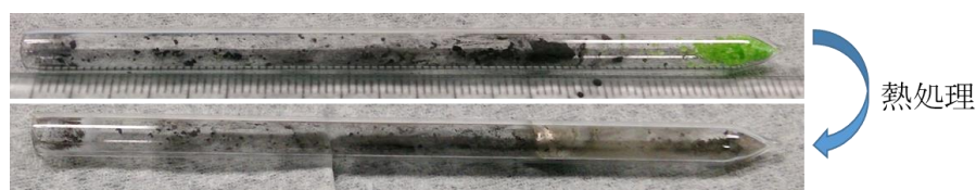
図 2.56 : 熱処理前後の原料と反応容器の光学写真
