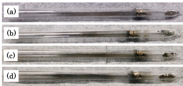
図 2.39 熱処理後の原料と反応容器の光学写真(a)15 分(b)30 分(c)60 分(d)120 分
