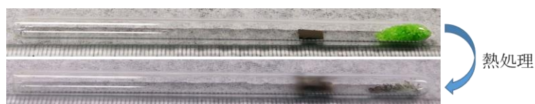
図 2.50：熱処理前後の原料と反応容器の光学写真
