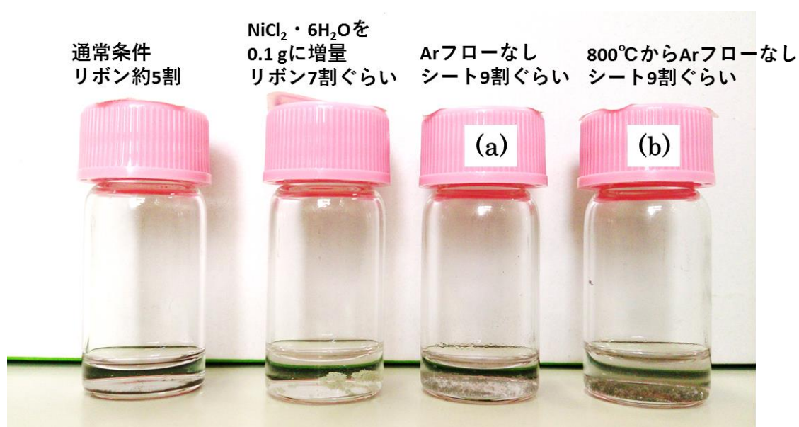
図 2.73 : エタノールに超音波分散させたのち、静置した試料の光学写真(a)最初からフローなし(b)800°Cからフローなし
