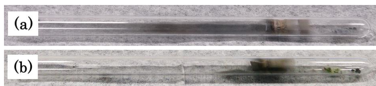
図 2.61：熱処理後の原料と反応容器の光学写真(a)800℃あといい、(b)900℃あといい
