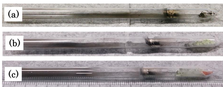
図 2.75：熱処理後の原料と反応容器の光学写真(a)0.05 g、(b)0.1 g、(c)0.2 g
