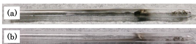
図 2.72 : アルゴンガスフローなしで熱処理した原料と反応容器の光学写真(a)最初からフローなし(b)800°Cからフローなし
