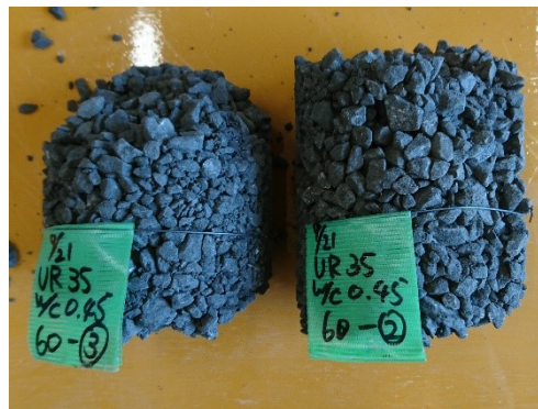
写真-3.2 骨材の剥落が生じた POC (25°C 超, VR = 35\% , 低速撈拌時間 60 分)
