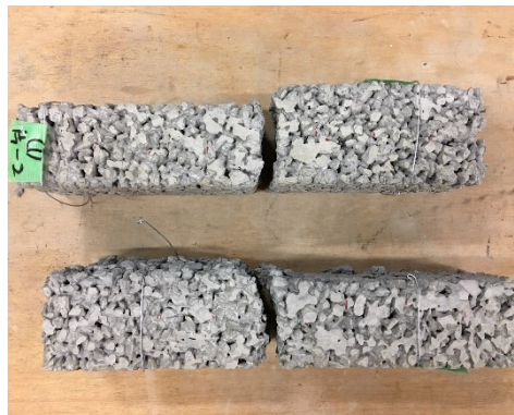
写真-6.1 脱型後の試験体の形状の例
