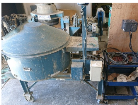
写真－3.1 フレッシュ POC の低速攪拌に用いた一軸強制パン型ミキサとインバータ
