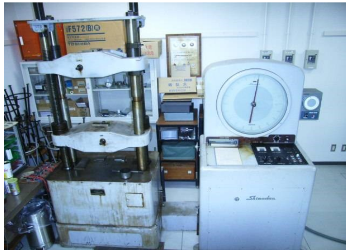
Fig. 2.18 万能試験機(島津製作所製, REH-50 型)
