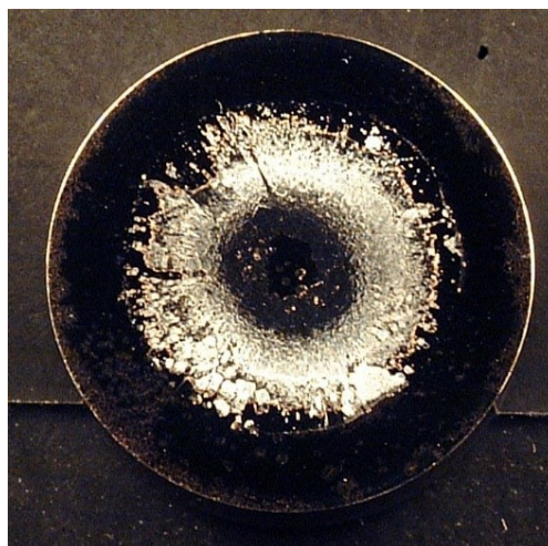
Fig.3.2 圧縮後工具表面(Tool-1, t-4, A1050-H, e_c=52\% , \gamma=82\% )
