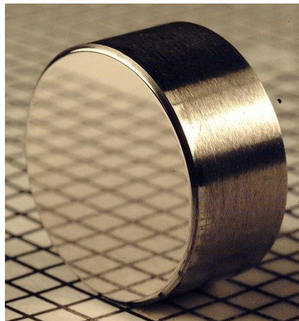
Fig. 2.6 研磨後の工具表面(Tool-1)
