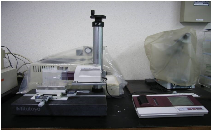
Fig. 2.20 触針式表面粗さ計(Surftest SJ-400)の外観
