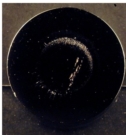
Fig.3.18 圧縮後の工具表面の外観(Tool-2, t-4, A1050-H, e_c=44\% , \gamma=9\% )
